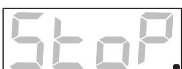
Desetinná tečka vpravo dole pulzuje podle toho, jak snímač DES odpovídá na dotaz na polohu. Pokud tečka nesvítí nebo pulzuje nepravidelně, dochází k rušení komunikace. V takovém případě zkонтrolujte zapojení a neporušenost datového kabelu DES a nastavení [DIP7](#).
